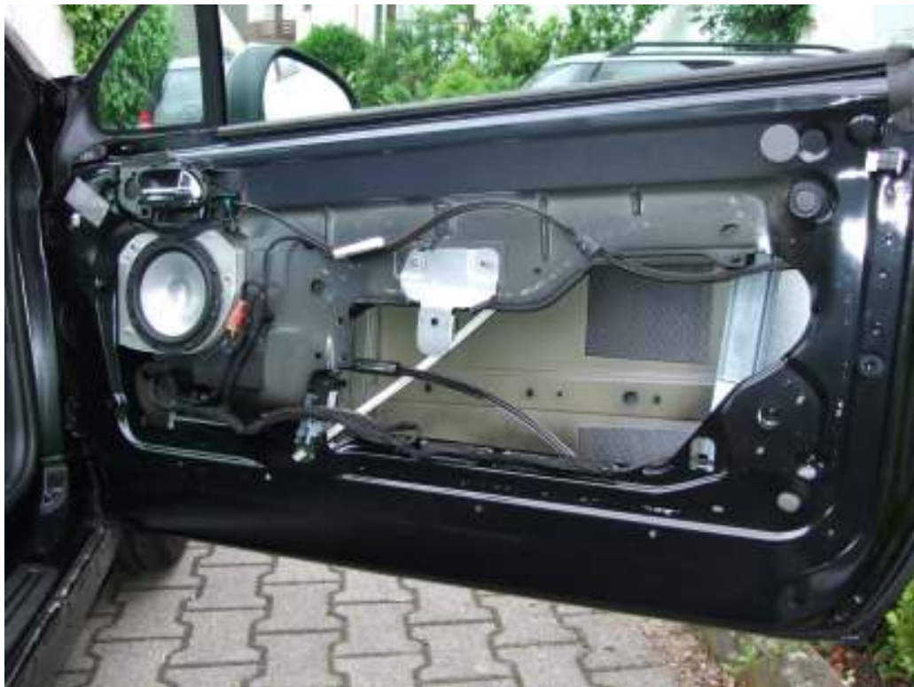
Schutzfolie entfernt
