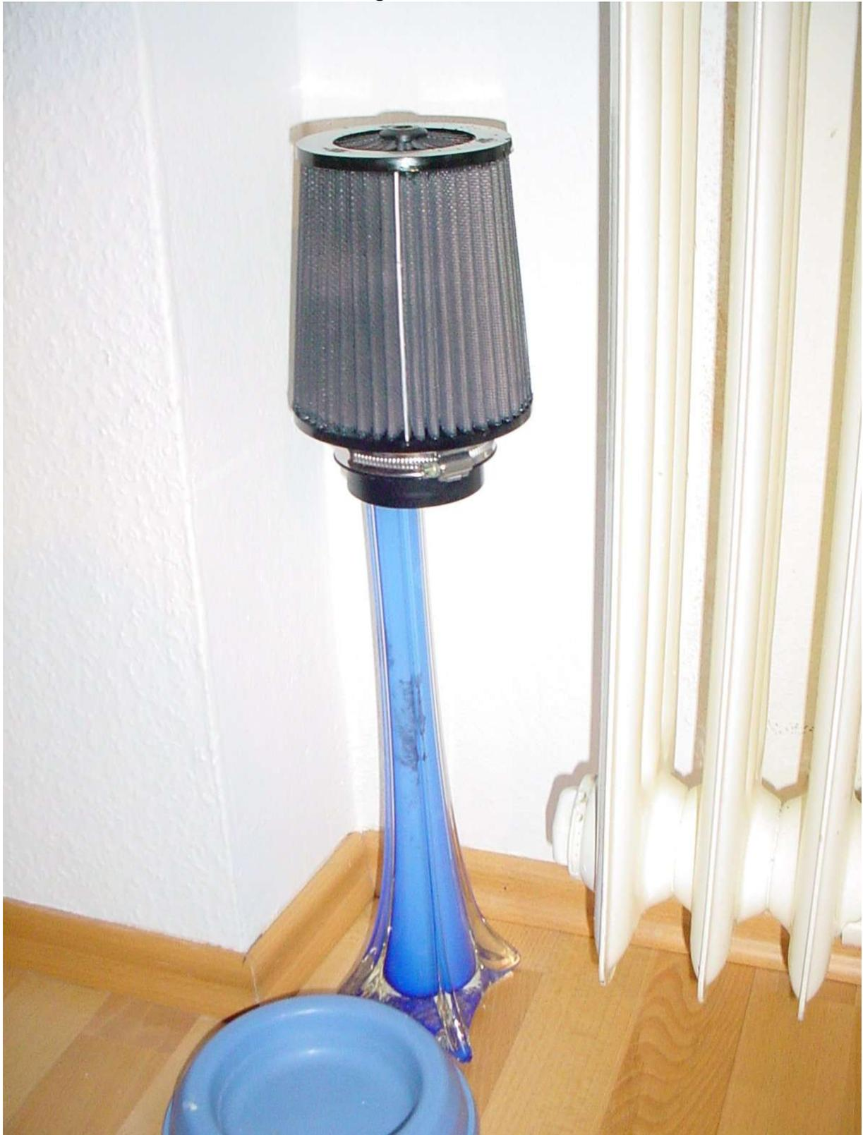
Nach dem Trocknen (ca. 2-3 Stunden) wird der Filter mit dem K&N Filteröl eingesprüht, bis der Filter gleichmäßig genug Öl hat (hab ich selber ned ganz verstanden aber ihr spürt wie ich denke). Das sieht dann in etwa so aus
