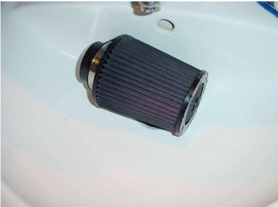
Jetzt den Filter mit wasser von innen nach außen auswaschen. Mit dem Duschkopf geht es wie ich finde am einfachstem. Wieder mit etwas Gefühl, da sonst der Filter beschädigt werden kann! Man sieht genau wo sich der Schutz schon gelöst hat und wo noch nicht.
