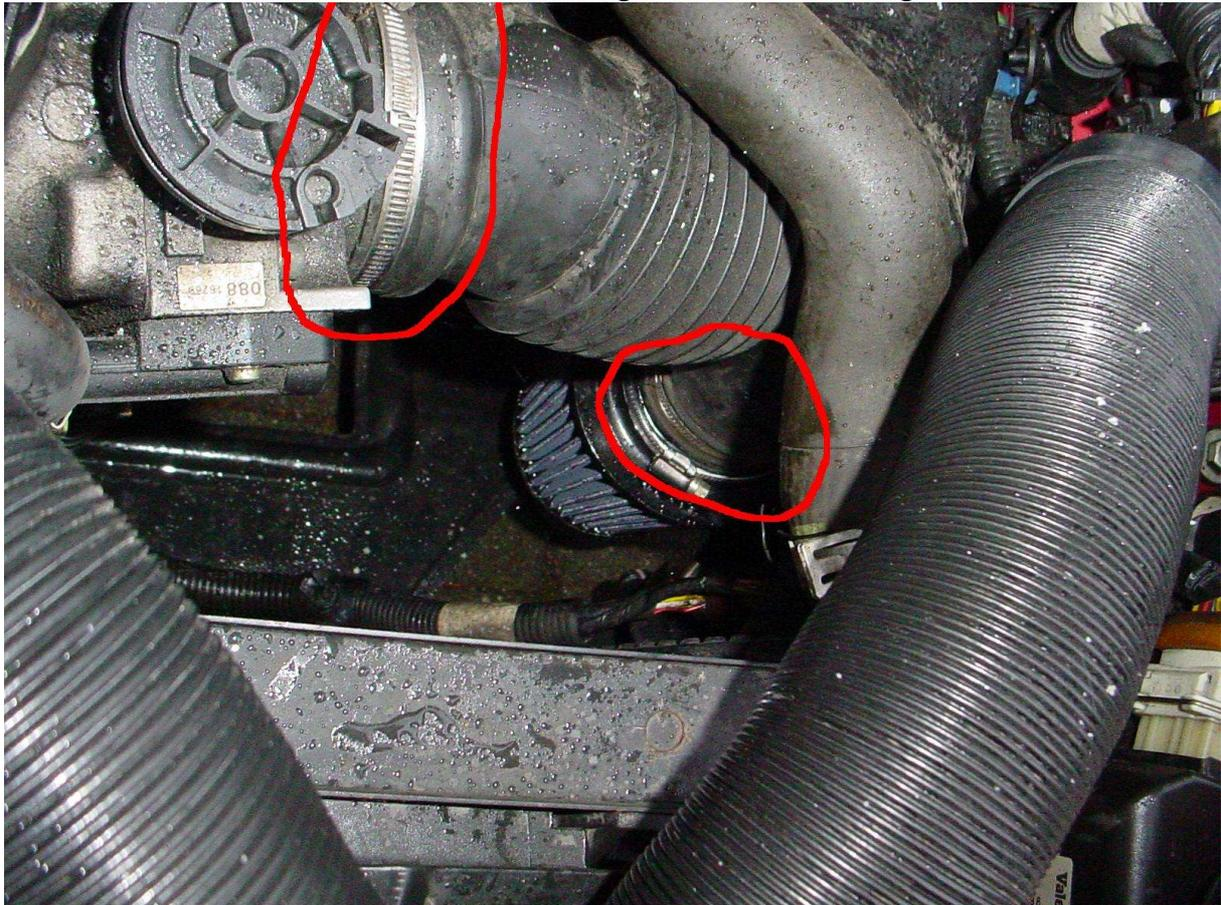
Danach werden die beiden Schlauchschellen (rot markiert) gelöst. Am Filter die obere Schlauchschelle lösen, damit der Stutzen mit raus geht. Jetzt den Schlauch von Filter zur Ansaugbrücke runter machen und sachte nach hinten weg drücken für mehr paltz.
