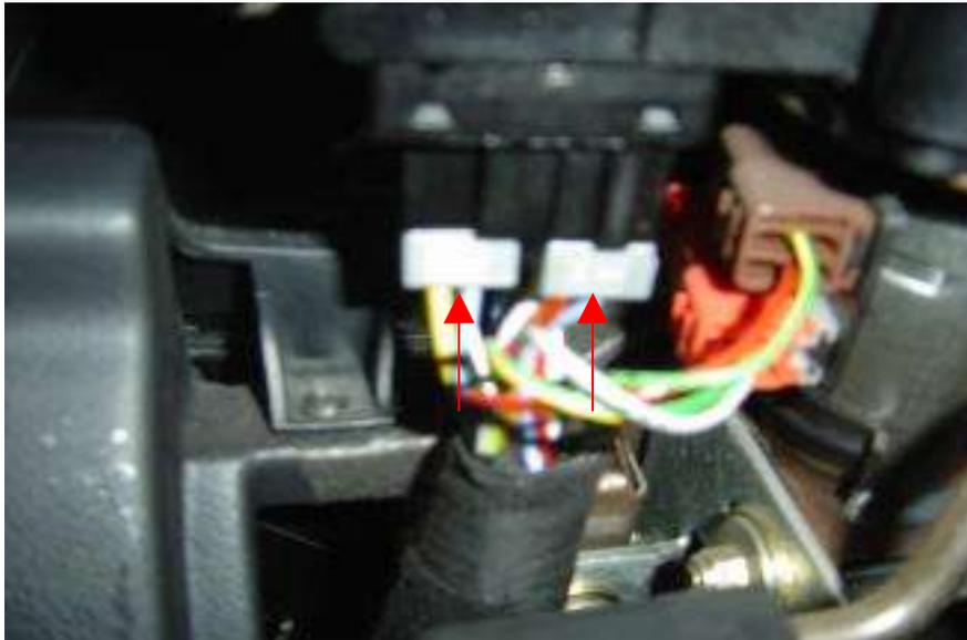
Um die Stecker die lösen befindet sich in der Mitte ein kleines schwarzes Teil, dieses nach hinten schieben und die Stecker können herausgezogen werden.
