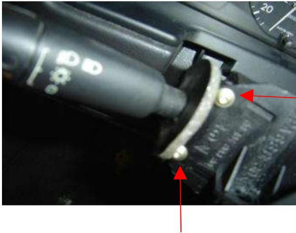
Jetzt die beiden Torxschrauben entfernen und der Hebel ist lose und kann nach links herausgeschoben werden.
