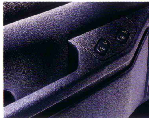
Ablagefach mit elektrischen Fensterhebern vorn (Option)
